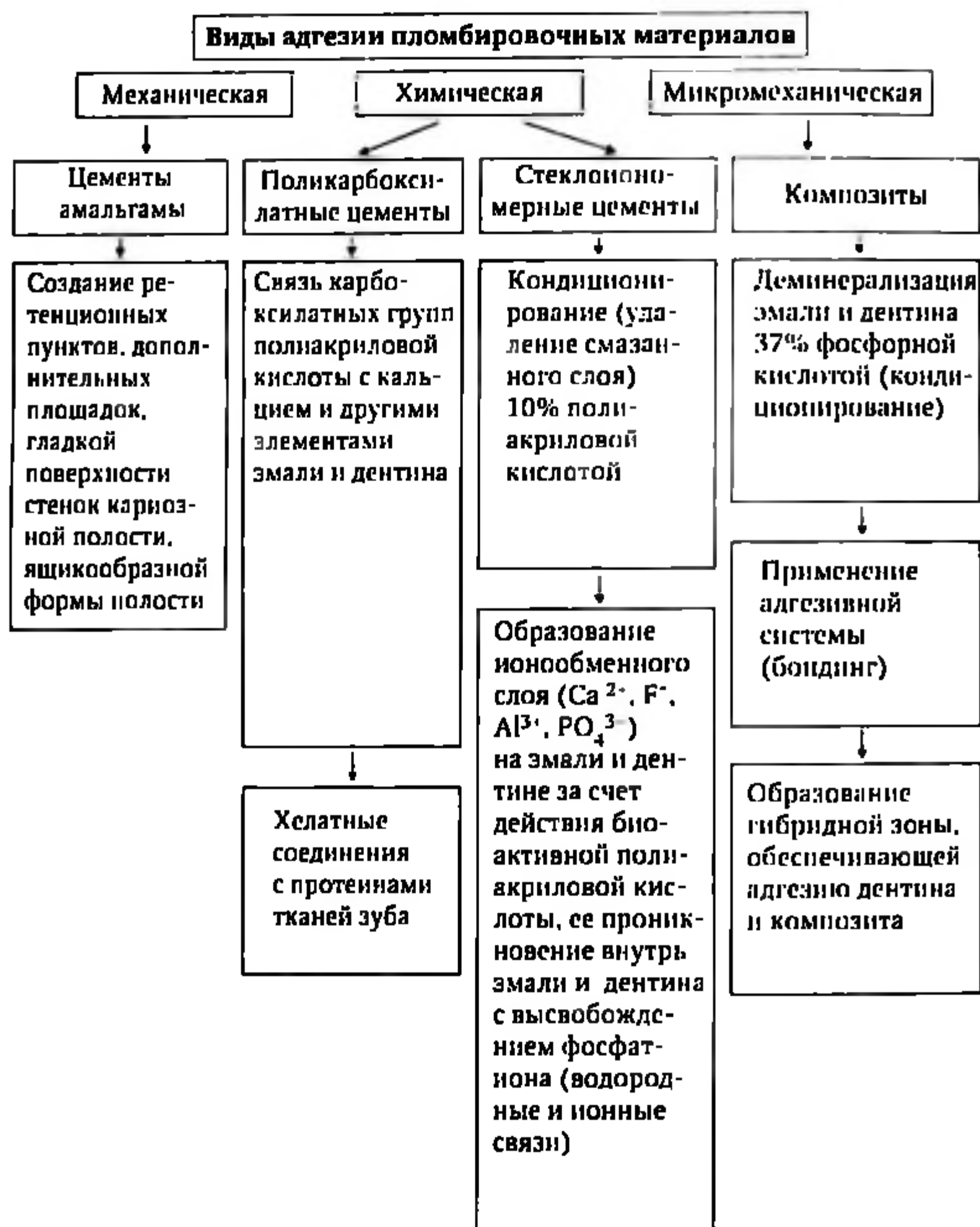
Рис. 8.56. Схема видов адгезии
