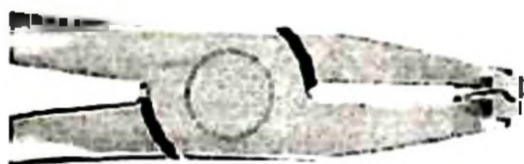
Рис. 3.341. Щипцы для нанесения детализирующих изгибов
