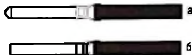
Рис. 3.410. Инструменты с закругленной (а) и плоской (б) торцевой частью хвостовика
