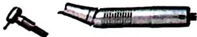
Рис. 3.441. Микро моторный наконечник со встроенным воздушным микро мотором и сменной головкой
