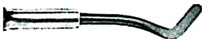
Рис. 3.91. Гладилка, покрытая танталом
