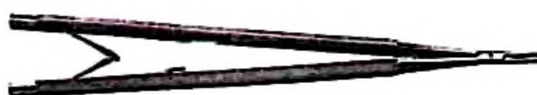
Рис. 3.233. Инструментальный зажим со стопорным ограничителем
