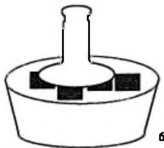
Рис. 8.28. Приготовление медной амальгамы: а — разогревание пластинок амальгамы над пламенем горелки; б — растирание разогретой амальгамы в ступке пестиком
