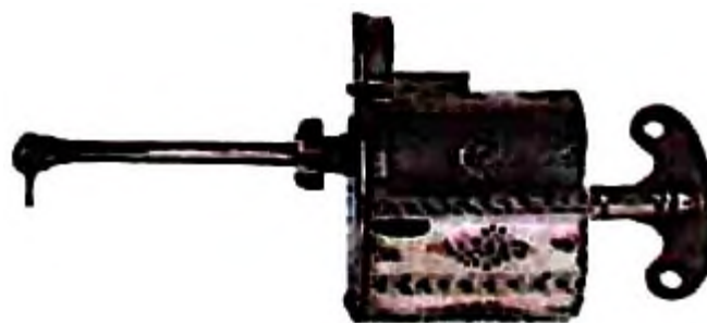
Рис. 2.8. Ручная бормашина с заводным устройством
