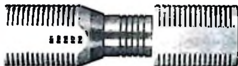
Рис. 3.330. Турель для изгиба прямой проволоки
