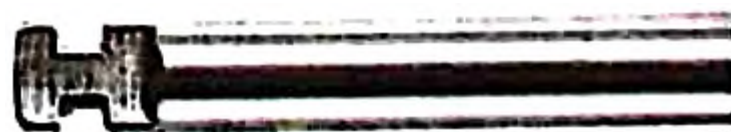
Рис. 3.411. Конструкция хвостовика инструмента для углового наконечника
