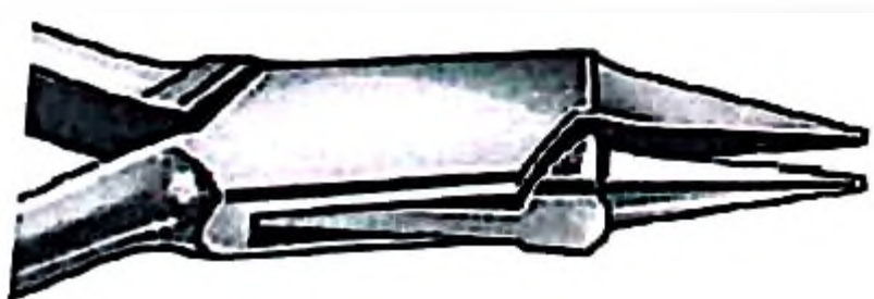
Рис. 3.333. Щипцы в форме птичьего клюва
