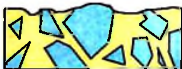
Рис. 8.42. Неравномерность полирования пломбы из макронаполненных композитов
