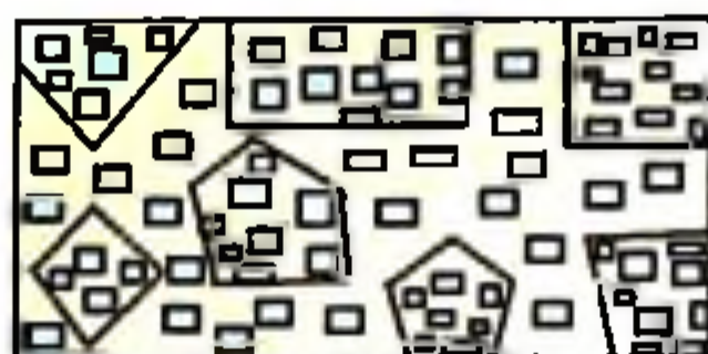
Рис. 8.45. Схема строения неомогенных микронаполненных композитов: □ — мелкодисперсные частицы диоксида кремния; ■ — преполимеризат; — — органическая матрица
