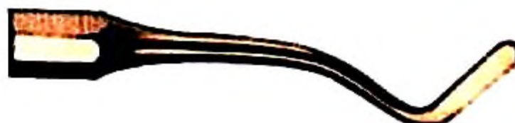
Рис. 3.92. Гладилка, покрытая нитридом титана
