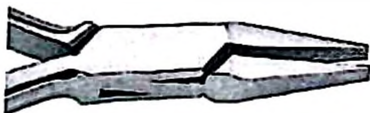
Рис. 3.331. Щипцы для выпрямления изогнутой проволоки
