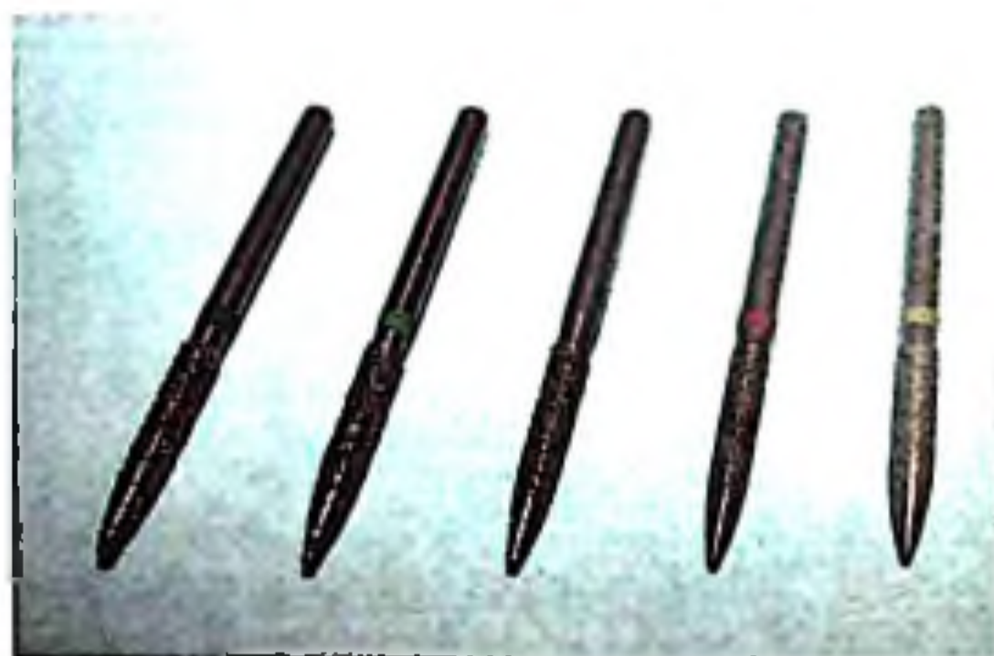
Рис. 3.418. Цветовое кодирование алмазных инструментов
