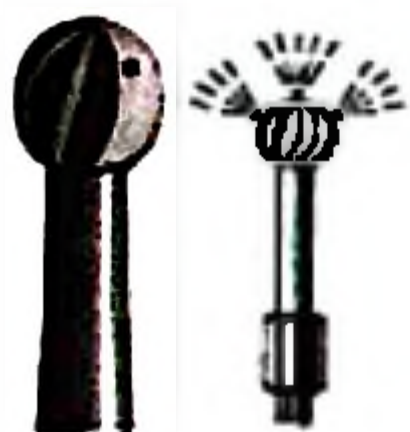
Рис. 3.388. Стальной бор с внутренней системой охлаждения
