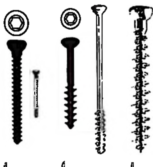
Рис. 4.7. Шурупы для накостного остеосинтеза: а — кортикальные; б — спонгиозные с частичной нарезкой; в — спонгиозный с полной нарезкой
