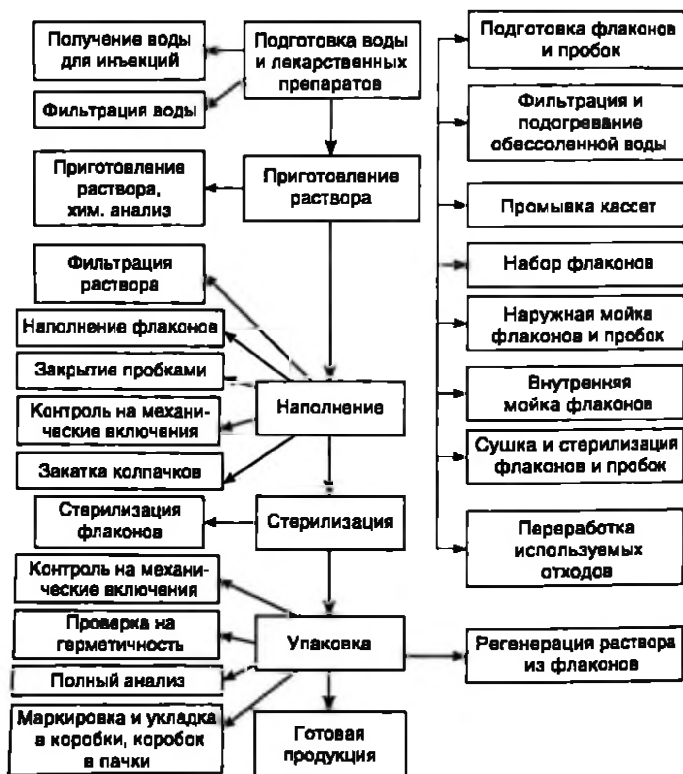
Схема 25.1. Технологическая схема изготовления инъекционных растворов
