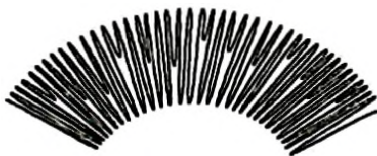
Рис. 3.29. Принцип укладки материала мембраны
