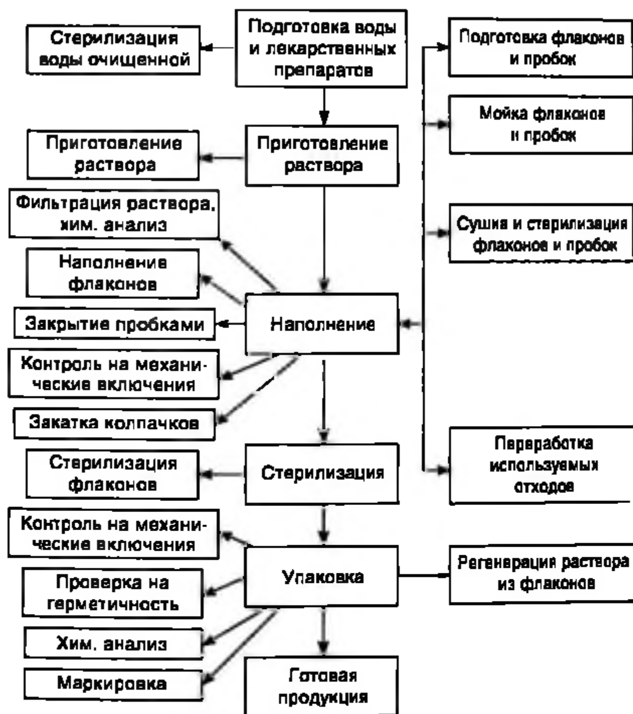
Схема 30.1. Технология получения глазных капель и офтальмологических растворов
